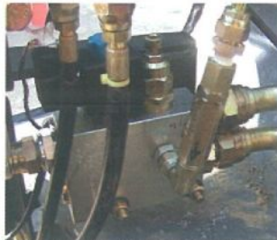
発電、作業機の操作性をそこなわない 流量・圧力調整弁
