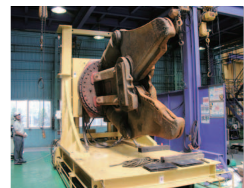
大型アタッチメントの修理用治具製作
