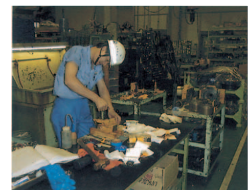
建機及びシールド用油圧ポンプの分解
