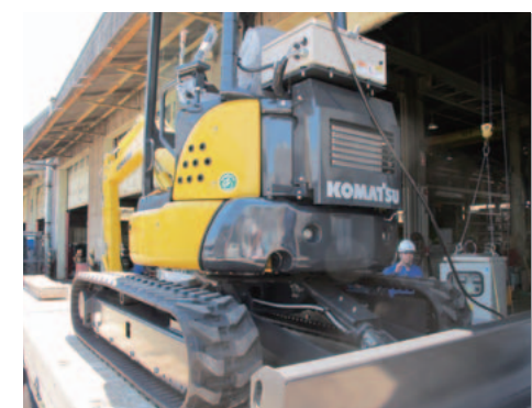
ミニショベルの電動化改造工事
