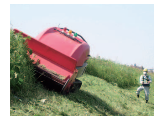
35度の斜面でも安全作業が可能な有人・無人対応型草刈機
