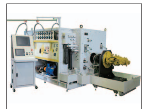
自社開発の油圧試験機(MH-R220)を用いた修理後の油圧機器の性能テスト
