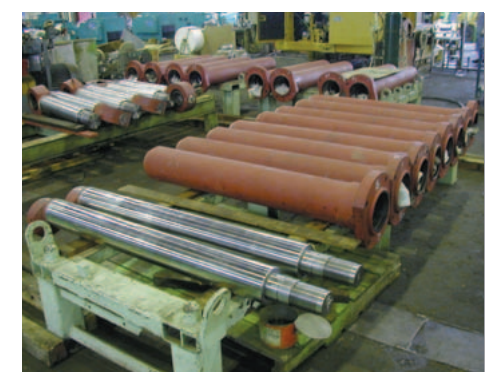
シールド用ジャッキのオーバーホール
