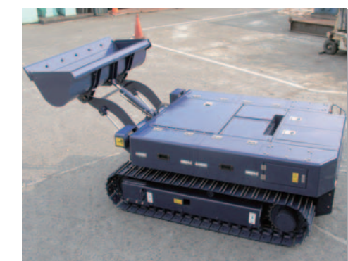
地上高87cmのラジコンブルドーザ(落鉋処理車)
