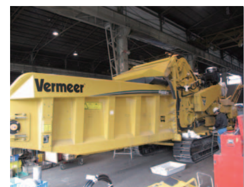
自社輸入木質系破砕機(バーミヤ社)の整備
