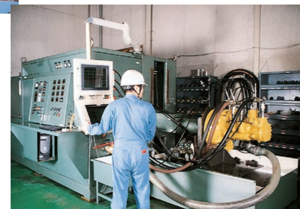
エネルギー回収型油圧試験機
