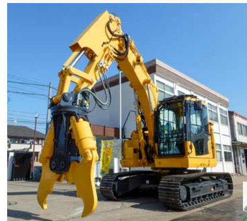
階上解体 階上解体専用作業機。ショート化することでアタッチメントクラスアップが可能になります。
