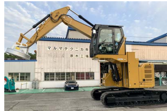
リフティングマグネット 金属スクラップのハンドリングや選別を、強力な磁力によりスピーディーに行えます。
