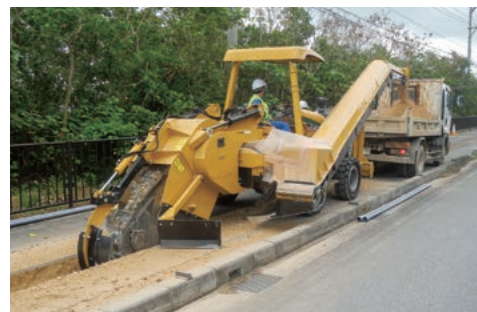
トレンチャー 長距離溝掘削専用機として、主に無電柱化や風力発電 の掘削工事、農業用の暗渠工事で活躍しています。
