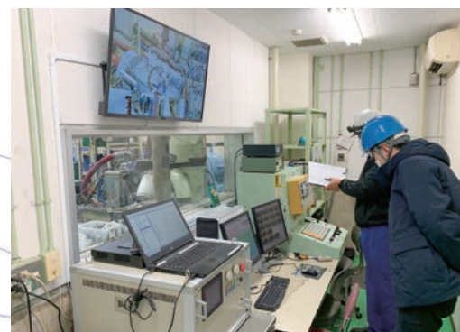
エンジンの負荷試験設備 エンジンの動力性能や燃費などを測定する装置です。特にオーバーホール後のエンジンの性能確認をします。(写真は隣接する制御室です。)
