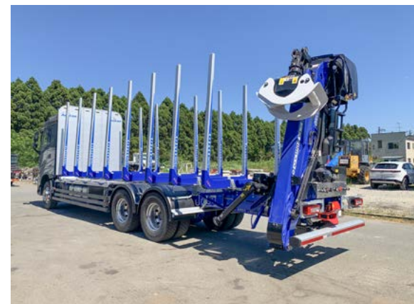
エプシロンクレーン 洗練されたデザイン、最新のFEM解析で計算された頑丈な躯体、 メンテナンス性と機能性に優れた構造を有し、マーケットシェア 世界No.1を誇ります。
