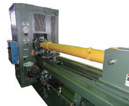
シリンダーリベアスタンド 大型油圧シリンダーの分解・組立・オイル漏れ検査をこのスタンド一台で行えます。締付トルク管理も行えます。
