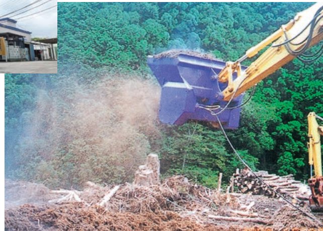
チップ散布機 チップをマルチング材として吹き付ける作業や、ゴルフ場の目砂散布、果樹園や農園の堆肥の散布・切り返し等が効率良く行えます。
