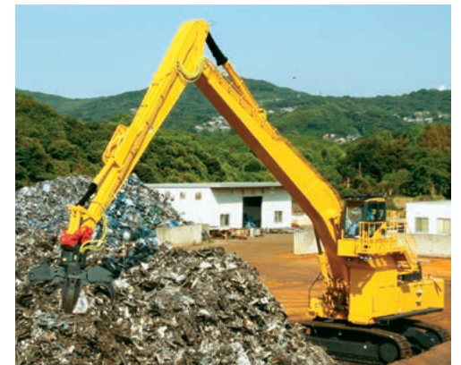
マテリアルハンドリング仕様車 ロングブーム・アームの先にグラブバケットを装備。スクラップの積み込み・荷降し、狭いスペースの高積み等に能力を発揮します。
