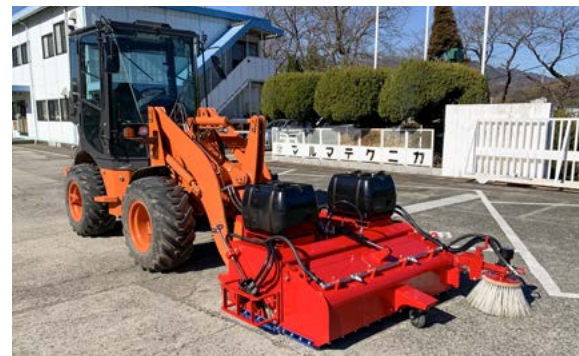
ロードスweeper 構内や道路等に飛散した土砂類を、強力な回転ブラシで素早くはき込みながら、効率よく清掃します。
