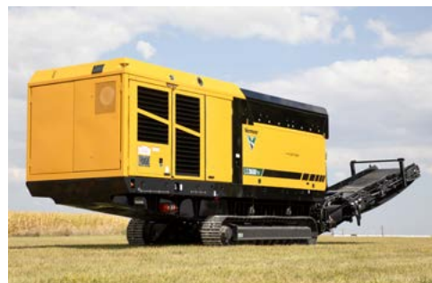
ロースピードシュレッダー（一軸低速破碎機） 建設廃材や根っこはもちろん、廃プラスチック、混合廃棄物、 枕木など、様々な産業廃棄物、一般廃棄物を効率的に 破碎することができます。災害時に発生する災害がれきの 処理にも活躍できる一軸低速破碎機です。
