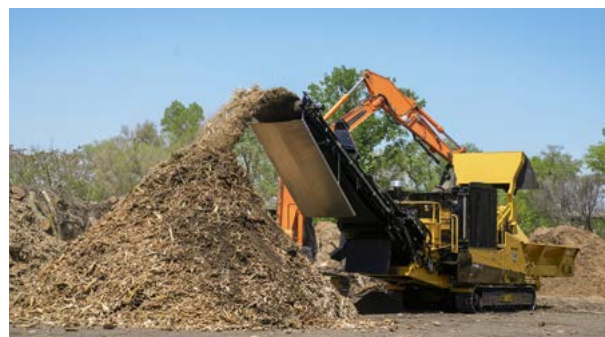
電動式/自走式水平グラインダー 破碎ドラムを載せ替えることにより、切削チップとピンチップの 生産を可能としました。騒音・振動・粉塵を抑えた電動式と、 効率の良い取り回しが可能な自走式が選択可能です。
