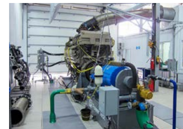
エンジン動力計 周辺機器の選定やレイアウトなど、お客様のニーズをお聞きしながら、制御計測盤、排気処理、水冷却システム、燃費計測、エンジン架台、各接続アダプターなどのご提供を致します。
