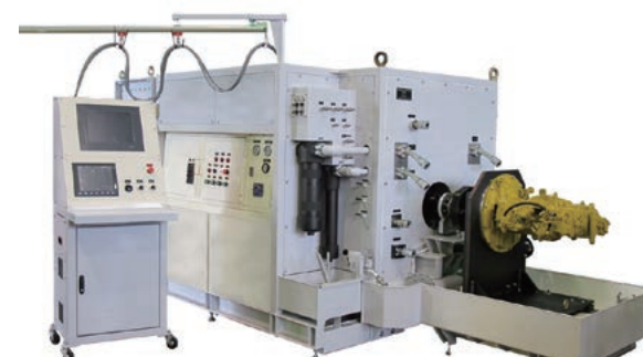
回生型油圧試験機 油圧ポンプ・モーターの性能確認試験機で作業性に優れ、回生回路により消費電力を削減できます。
