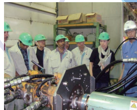
油圧テスターによる性能試験
