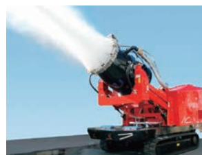
ハイパーミストブローワー車 毎分7,000リットルの放水と、風速毎秒40mでミストを噴霧することが可能で、消火活動を行うと共に、周辺の温度を下げて消防士の突入を支援できる無線操縦式放水車です。
