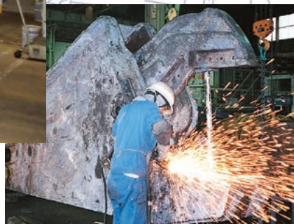
解体用アタッチメントのツール加修風景 長年培ってきた溶接技術によって、さまざまな消耗部品の肉盛再生を行います。
