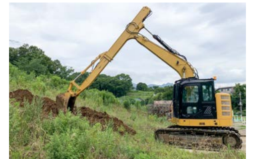
ボックス式スライドアーム 業界トップクラスのスライド量により都市土木をはじめ建築基礎工事、立坑掘削、河川浚渫、法面作業など幅広い現場で威力を発揮します。アウターバケットシリンダーでの力強い掘削力と箱型構造で耐久性に優れております。
