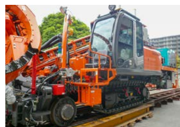
軌陸車 油圧ショベルに車輪を設ける改造を行い、軌道(線路)と陸上の両方を走行できるようになります。鉄道施設の保守作業や資材運搬など、鉄道関連工事で幅広く活躍します。
