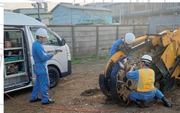
フィールドサービス 必要とされる現場に迅速かつ効果的に到着し、機械の整備・点検作業を実施します。(写真はサービスカーを用いたトレンチャー修理をしている様子です。)
