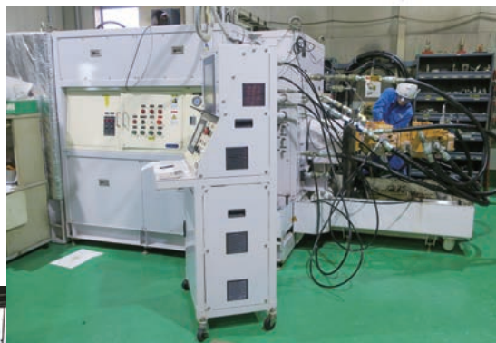
油圧ポンプ・モーターの負荷テスト 油圧ポンプ・モーターの整備後には自社製の試験機で性能を確認します。これによって高い整備品質を誇っています。
