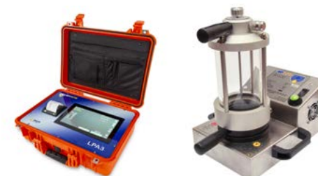
オイル清浄度測定器 作動油中の粒子であるコンタミネーション(汚染物)の計測器です。作動油(潤滑油)の清浄度を適切に管理することができます。
