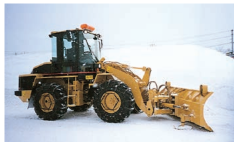
除雪ドーザー ドーザーの角度の変更が簡単に行え除雪作業がスピーディーに行えます。
