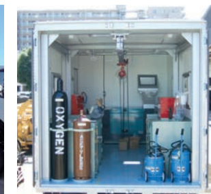
工作車 修理設備を搭載した車両です。特に海外の工事現場ではワゴン車から大型車まで修理目的に応じた工作車や給油車が活躍しています。
