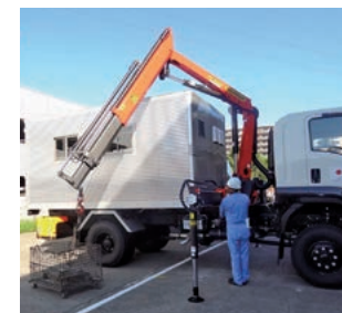
工作車 修理設備を搭載した車両です。特に海外の工事現場ではワゴン車から大型車まで修理目的に応じた工作車や給油車が活躍しています。
