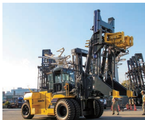
シャースタッカー 港湾でトラックシャースを縦置きにして保管するためのフォークリフト用アタッチメントです。フォークリフト本体は25tクラスです。
