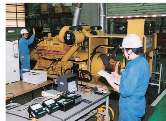
発電機の負荷テスト 1500kVAまでの大型発電機負荷テストに対応でき、NEGA(日本内燃力発電設備協会)基準に基づき試験を実施します。
